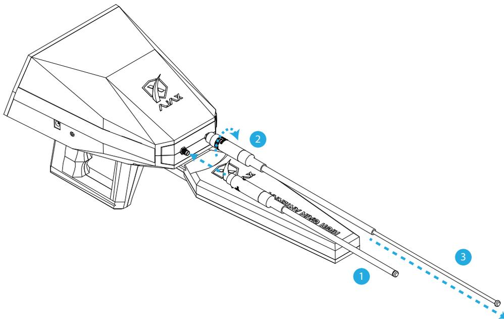
figure 6 - Montaje de Antena de Seguimiento
